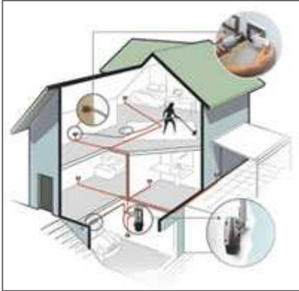
Este sistema se apoya en un funcionamiento muy sencillo. La separación de la central de aspiración y el tubo flexible, unidos el uno al otro por tuberías de conducción.
